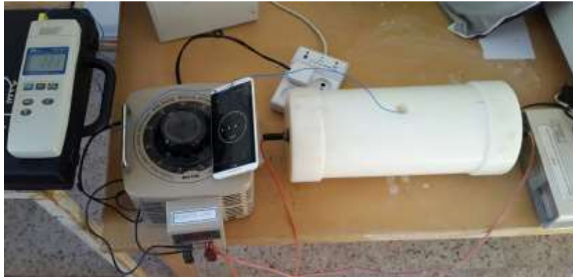
شکل ۱. سامانه گرمایش اهمی و اتصال آن به رگلاتور ولتاژ و دماسنج.
