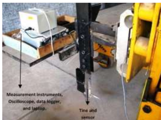
Figure 7. Dielectric-based sensor for measuring soil moisture content (Naderi-Boldaji et al., 2011) شکل ۷- سنسور مبتنی بر خواص دی الکتریک برای اندازه گیری رطوبت خاک (Naderi-Boldaji et al., 2011)
