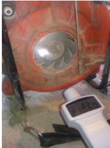
شکل 2. اندازه گیری دور با استفاده از دستگاه دورسنج
