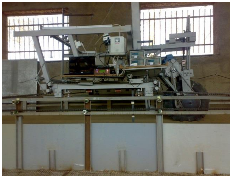
شکل ۱- حامل سویل بین و آزمونگر تک چرخ مورد استفاده به همراه سیستم تحصیل داده
