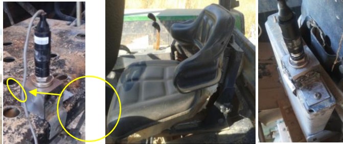
شکل ۲- (A) محل قرارگیری سنسور شتاب سنج روی صندلی
