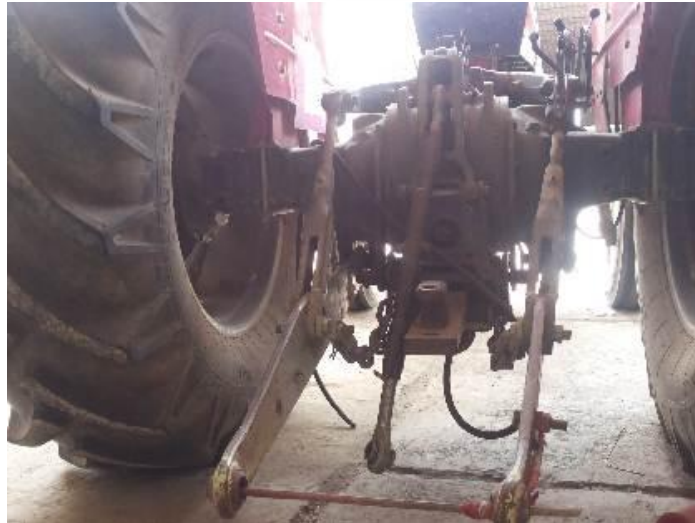
شکل ۲- تصویر سیستم هیدرولیک و مکانیزم اتصال سه نقطه تراکتور مسی فرگوسن MF285
