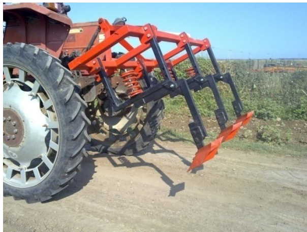
شکل ۳- کولتیواتور ردیفی سوار بر تراکتور شاسی بلند
