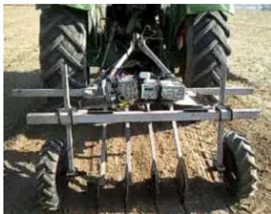
شکل 1- دستگاه در حین اندازه گیری هدایت الکتریکی ظاهری خاک
