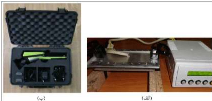
شکل 1- الف) گرم کن صفحه‌ای. ب) دوربین گرمانگاری فروسرخ یو.آل.آی. آر ویژن مدل TI160.
