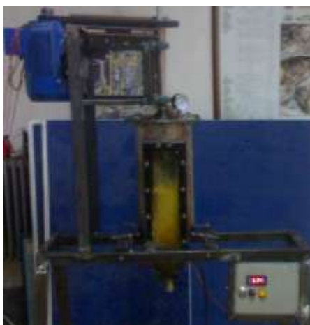
شکل 2- راکتور مخزنی همزن دار بچ ساخته شده در دانشگاه ارومیه
