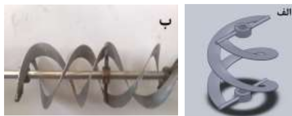
شکل 1- همزن هلیسی شبه ریون. الف) طراحی شده با نرم‌افزار SolidWorks. ب) ساخته شده.
