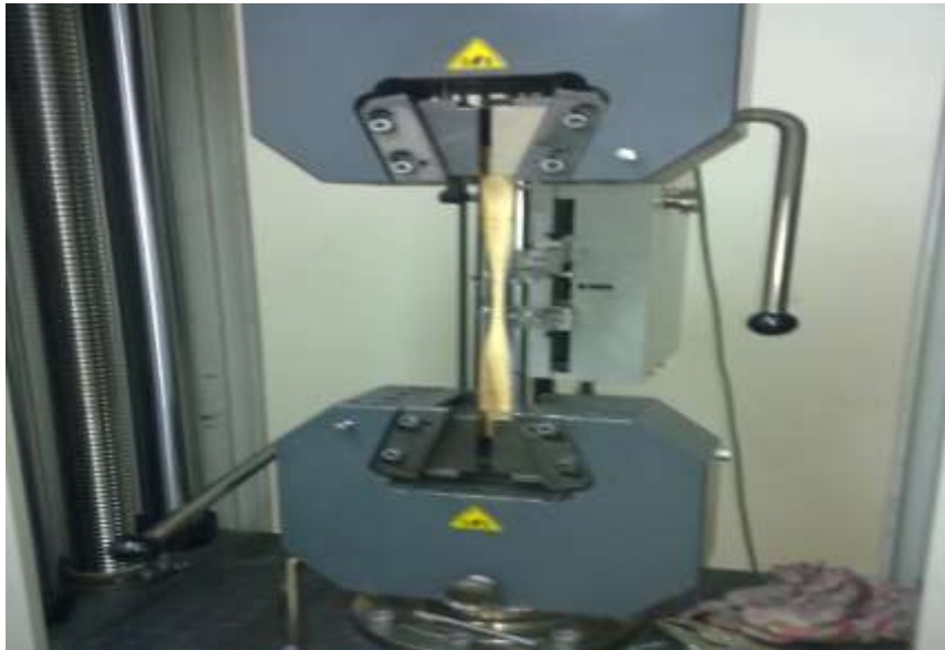
شکل 3: نحوه قرار دادن نمونه در دستگاه آزمون کشش
