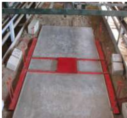
شکل 2. نحوه قرار گیری مانع در مقابل چرخ و میله های اتصال مانع در داخل کانال خاک
