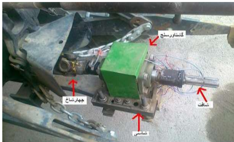
شکل 3: دستگاه گشتاورسنج ساخته شده متصل به تراکتور
