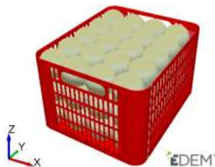
شکل ۲- مدل سه بعدی جعبه و ذرات (سیب) ایجاد شده در نرم افزار المان مجزا
