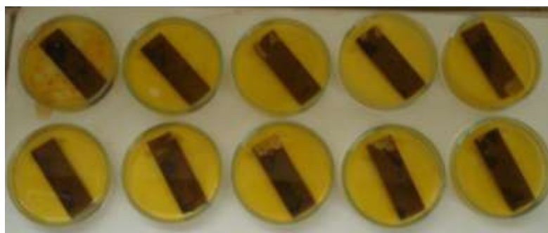
شکل 1: نحوه قرار دادن نمونه ها در محلول خورنده
