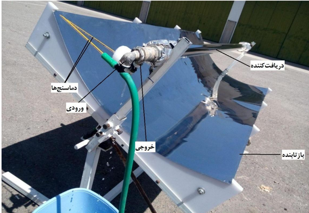
شکل ۲. متمرکزکننده خورشیدی سهموی
