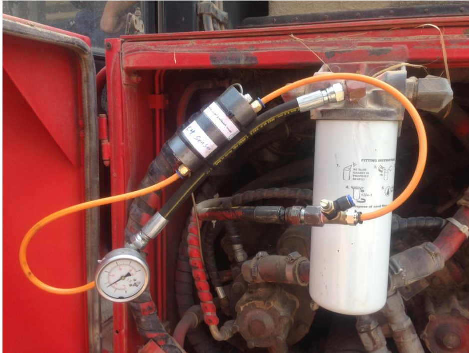
شکل ۱۰ حسگر C4 ساخته شده در موسسه تحقیقات و آموزش توسعه نیشکر روی دروگر ۷۰۰۰
