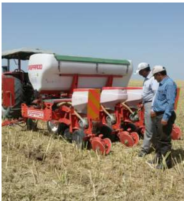
شکل ۲- دستگاه دقیق کار کشت مستقیم (نوتیلج) ساخت شرکت ماسکیو گاسپاردو الیایتا- مدل رجینا
