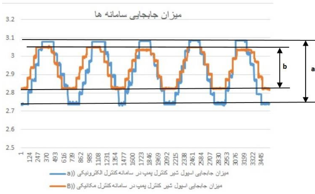
شکل ۳ میزان جابجایی اسپول شیر کنترل پمپ هیدرولیک در سامانه های کنترلی مختلف
