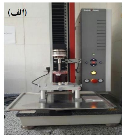
شکل ۱-الف- دستگاه بافت مواد، آزمون بک اکستروژن ب- نمودار ترسیم شده تست بک اکستروژن بر حسب نیرو-جابجایی
