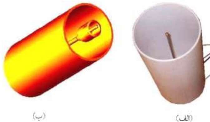
شکل 1: کاوشگر ضریب رسانش گرمایی نصب شده در مرکز استوانه
