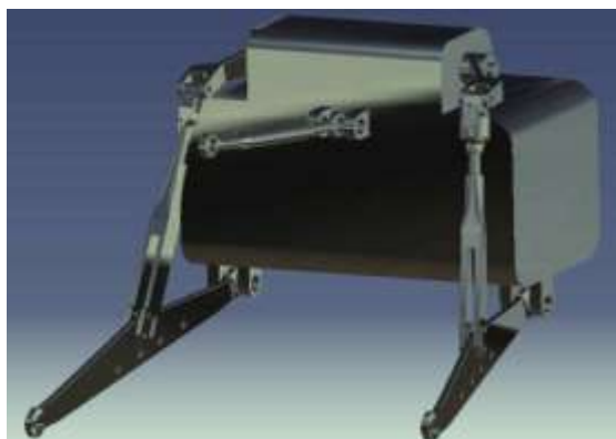
شکل 2: مدلسازی اتصال سه نقطه در نرم افزار کتیا
