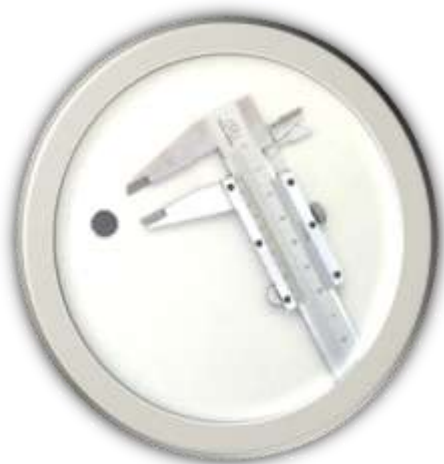
شکل 4) تصویر گرفته شده از یک جسم مبنا برای کالیبراسیون
