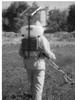
شکل 2- عملیات سمپاشی در مزرعه با سمپاش میکروزر خورشیدی
