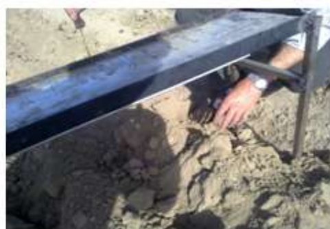
شکل ۱: سازه ساخته شده به منظور اندازه گیری فاصله منحنی خاک با سطح مینا و ترسیم منحنی خاک
