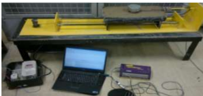
شکل 5: نمایی از دستگاه مورد استفاده برای تعیین ضریب اصطکاک خاک و فلز و چسبندگی
