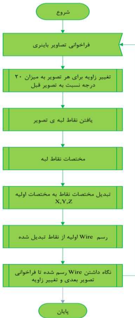
Fig 1: The reconstruction algorithm of apple wire-frame model. شکل ۱- الگوریتم بازسازی مدل Wire-Frame سیب.
