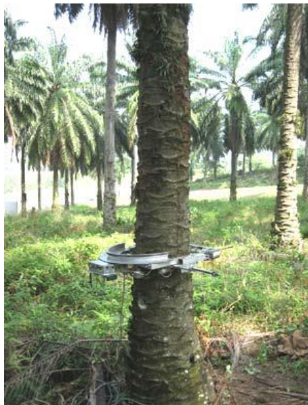
شکل ۸: ربات در حال بالا رفتن از درخت در مرحله تست در مزرعه
