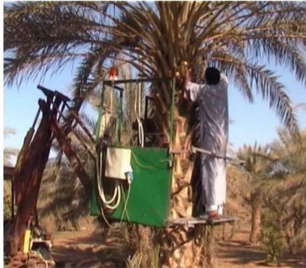
شکل ۲۳: توسعه خدمات نخل خرما با نصب دستگاه بر روی تراکتور
