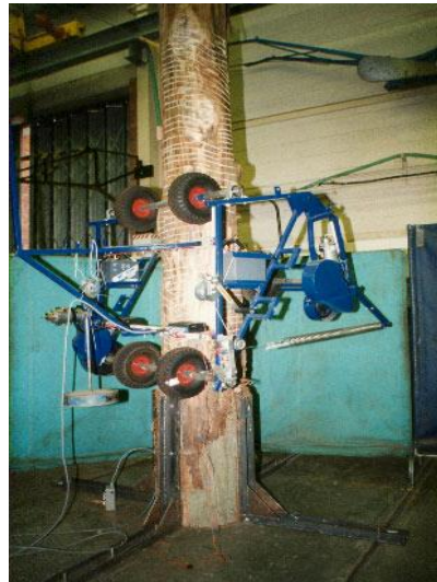
شکل ۵: ماشین چرخ‌دار بالا رو از درخت نمونه مکاترونیکی
