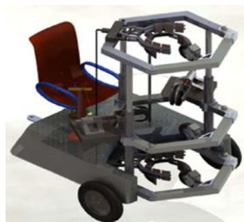
شکل ۶: مدل بالارو هیدرولیکی، مکاترونیکی
