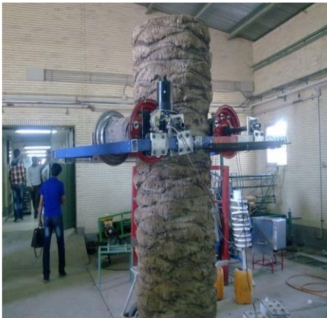
شکل ۹: ماشین آزمایشی هنگام بالا رفتن از درخت
