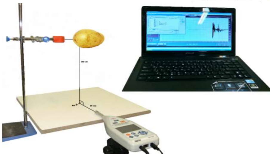
Figure 1 Data Acoustic Imitate System شکل ۱ سامانه اخذ داده‌های آکوستیکی
