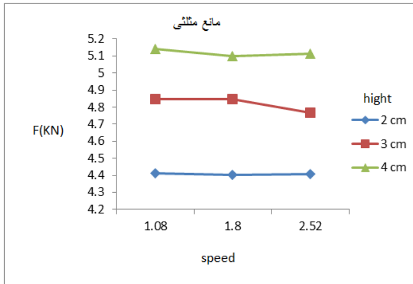
شکل 4 اثر سرعت پیشروی بر ضربه دینامیکی در ارتفاع های مختلف بر مانع مثلثی شکل
