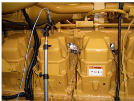
شکل (۱). سامانه ارتعاشات و صدا توسط شتاب سنج و میکروفن از موتور دیزل
