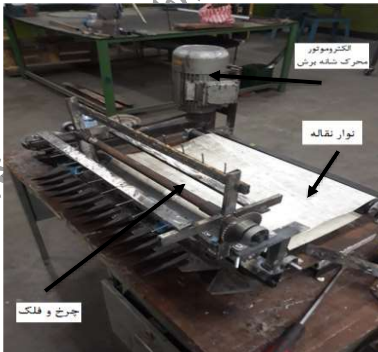
شکل ۴- مکانیزم چرخ و فلک و نوار نقاله جمع‌آوری
