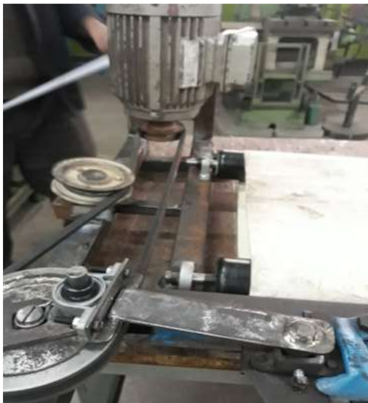
شکل ۲- مکانیزم تبدیل حرکت دورانی به رفت و برگشتی
