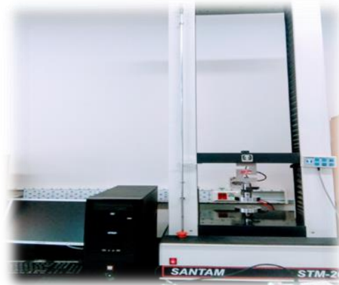
شکل (1) نمای کلی دستگاه آزمون مواد STM-20
