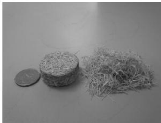
شکل ۱- نمونه‌های ساخته شده از فیبرهای نیشکر در پژوهش پوترا و همکاران (۲۰۱۳)
