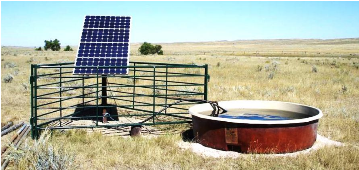
شکل ۲. سیستم فتوولتائیک برای آبشخور دام ( cespkenya.com ).
