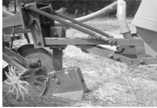
شکل ۲- شیار بازکن چیزل باله دار به همراه ضمیمه ردیف تمیزکن مورد استفاده در تحقیق ثانوی و رنوفت ۱۳۸۶
