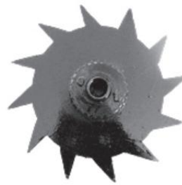
شکل ۴- پیش بر دندان دار محرک استفاده شده در تحقیق نژادی و رنوفت ۱۳۹۰
