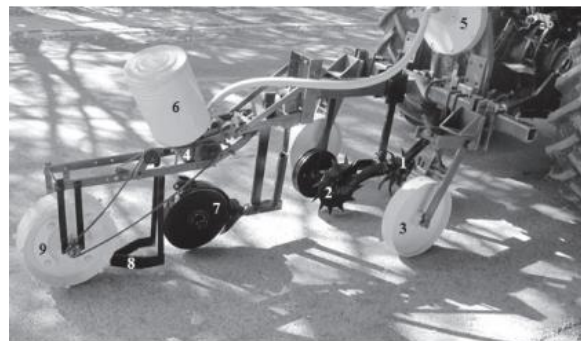
شکل ۵- کارنده سوار شونده استفاده شده در تحقیق نژادی و رنوفت ۱۳۹۰، ۱- ضمیمه تمیز کن ردیف ۲- پیش بر دندان دار ۳- چرخ تنظیم عمق ۴- واحد اندازه گیری پنوماتیک بذر ۵- فن ۶- مخزن بذر ۷- شیار بازکن دو دیسکی ۸- پوشاننده ۹- چرخ فشار دهنده
