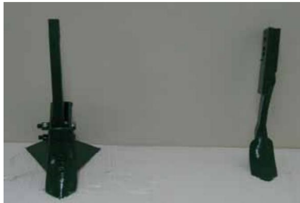
شکل ۱- شیار باز کن چیزل و شیار باز کن چیزل باله دار مورد استفاده در تحقیق ثانوی و رؤفت ۱۳۸۶
