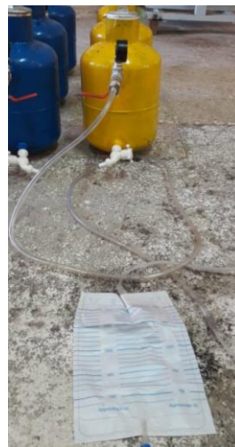
شکل 2: کیسه‌های مخصوص جمع‌آوری بیوگاز
