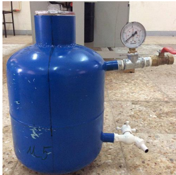
شکل ۱: هاضم تهیه شده پس نصب اتصالات
