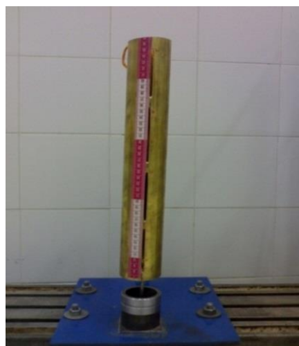
شکل ۹. شماتیک و دستگاه ساخته شده برای آزمون ضربه‌ای ارائه شده توسط محمدی قرمزگلی و همکاران، (۱) ریسمان، (۲) درجه، (۳) سیلندر، (۴) وزنه، (۵) گردو، (۶) صفحه صلب
