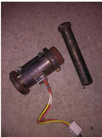
شکل ۲ سیلندر و پیستون به همراه کمربند حرارتی
