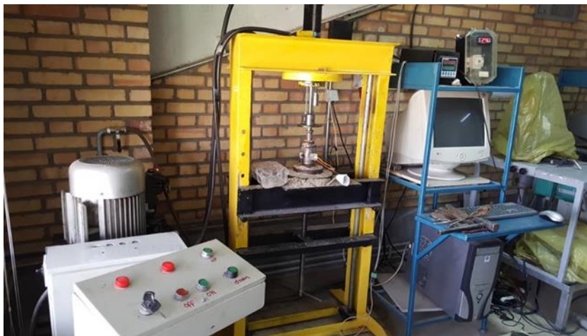
پرس هیدرولیکی مورد استفاده برای تولید بریکت
