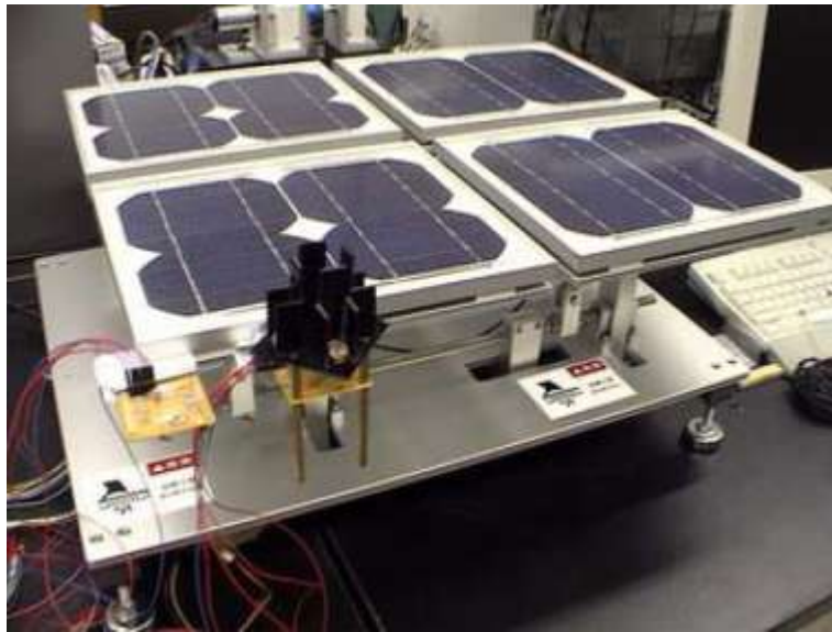
شکل 1. ردیاب خورشیدی به همراه صفحات فتوولتائیک
