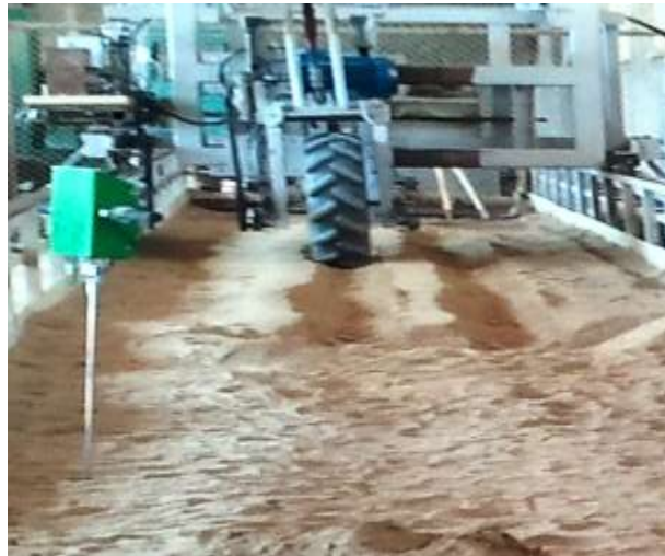
شکل 1. نمای کلی انباره خاک و آزمونگر تک چرخ
