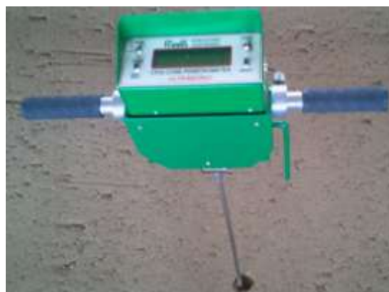
شکل 2. نفوذ سنج مورد استفاده برای ارزیابی مقادیر فشردگی
