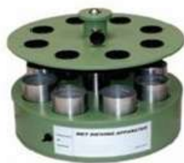
تصویر 2: دستگاه الک تر مدل 8/13.
