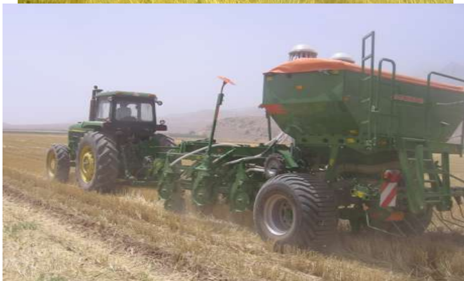
دستگاه کشت مستقیم بالدان (شکل بالا)، دستگاه کشت مستقیم آمازون (شکل پائین)
