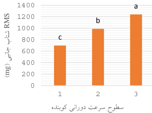
شکل ۵- تأثیر سرعت دورانی کوبنده کمباین روی مقدار RMS شتاب جانبی
