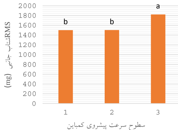
شکل ۶- تأثیر سرعت پیشروی کمباین در حال برداشت روی مقدار RMS شتاب جانبی
