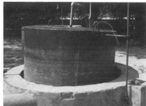
شکل ۷. دستگاه بیوگاز مدل عمودی.
