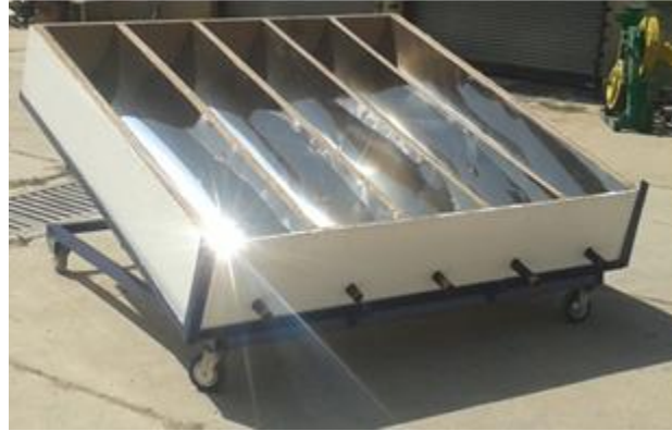
شکل ۲- کلکتور سهموی مرکب ساخته شده و مورد آزمایش
