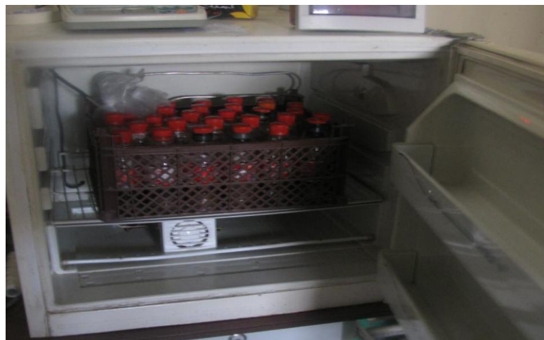
شکل ۲- انکوباتور ساخته شده به منظور کنترل دمای هاضم‌های تولید بیوگاز
