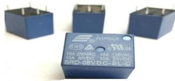
شکل ۶. رله‌ها جهت وصل و قطع کردن جریان
