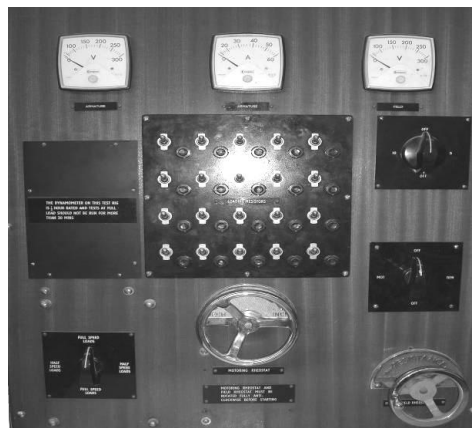
شکل ۳: پانل تجهیزات الکتریکی مربوط به موتور-ژنراتور
