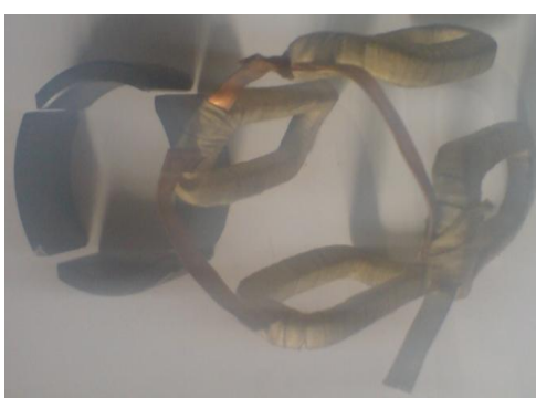
شکل ۵ - باز شده سیم پیچ‌های دستگاه و آهنربای طبیعی آن
