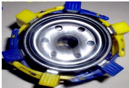
شکل ۱- جداکننده براده با آهنربای معمولی روی بدنه فیلتر
