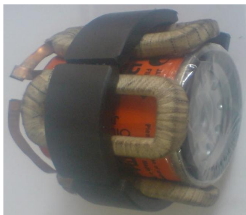
شکل ۴ - دستگاه در حالتی که هم سیم پیچ‌ها و آهنربای طبیعی بر روی بدنه فیلتر قرار گرفته اند
